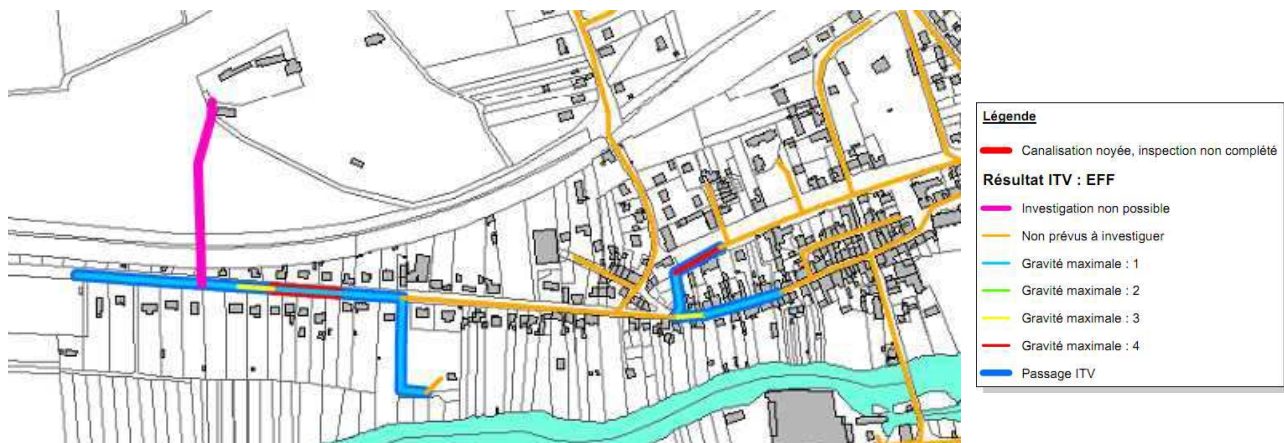
Figure 32 : Localisation des désordres selon l'indicateur Effondrement
