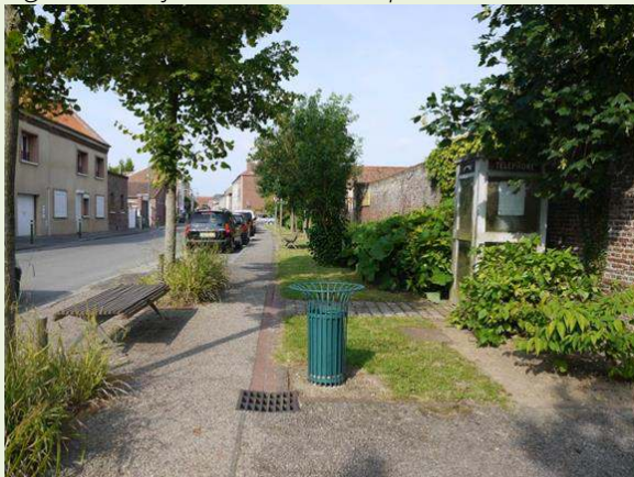
Emploi de mobilier urbain pour délimiter l'espace piéton
