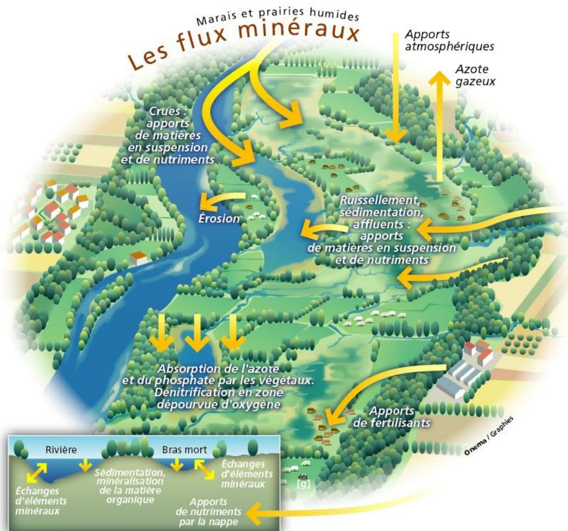
Figure 43 : Schéma du fonctionnement des flux minéraux dans les marais et prairies humides (source : www.zones-humides.org )
