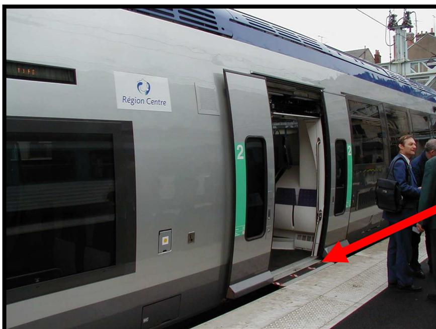
*Aucun obstacle à l'entrée dans le train (AGC) grâce à un comble-lacune entre le quai et l'intérieur du train*
