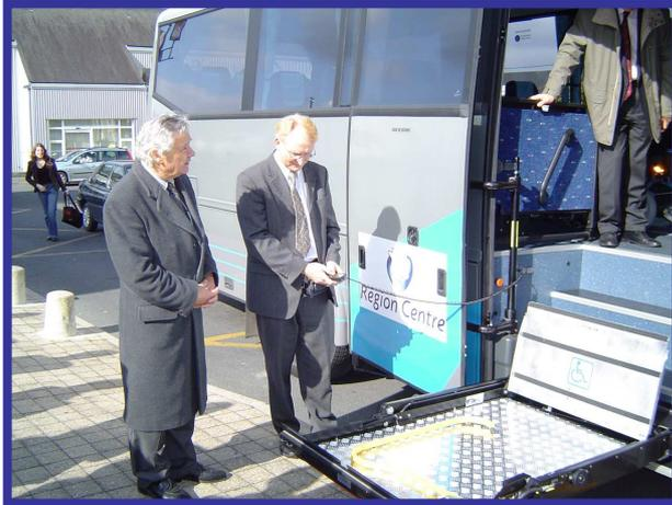
Deux autocars sont équipés d'un élévateur situé sur le côté du véhicule, sur la ligne mixte Tours – Chinon. Seuls les arrêts d'origine et de destination de cette ligne permettent aujourd'hui de déployer cet équipement.
